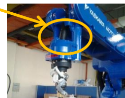
MA的情况下由于安装碰撞传感器时已经跟线缆组合在一起了，所以焊枪里面是没有的
