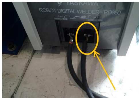
焊机上连接地线
