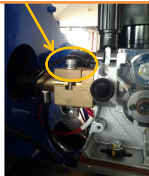
拧紧防拔固定螺栓后的状态
