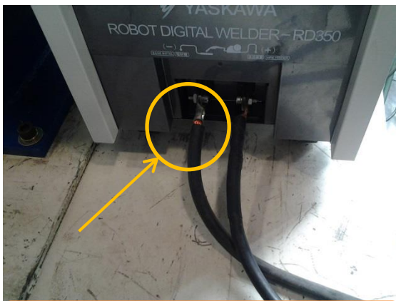
将地线与焊机(-)连接
