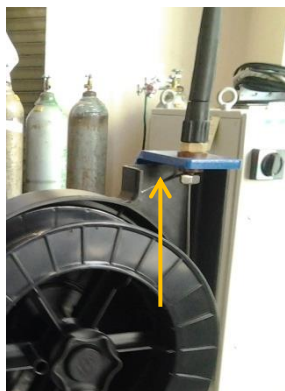
用手把焊丝接到软管内
