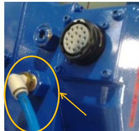
在一触式接头上安装气体管
