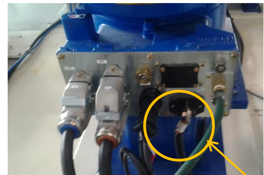
端子台上连接地线
