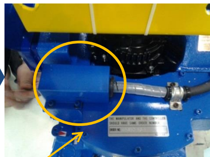
机械手·地线安装端子台
