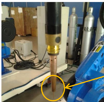
一直按着示教盒的送丝键进行送丝，直到焊丝从导电嘴处出来
