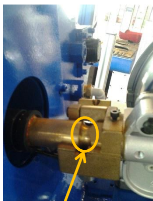
按照沟槽位置将插入电源线缆装到送丝装置上
