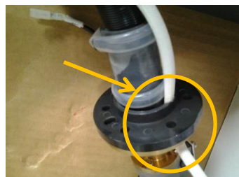
确认碰撞传感器线缆穿过法兰
