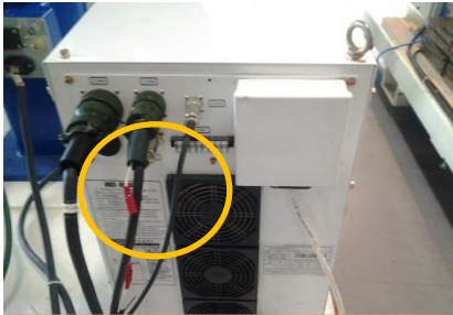
在焊机背面CON_7上连接电压检测线插头
