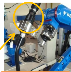
MH的情况下插入焊枪的螺丝部拧紧
