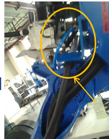
将地线固定在安装钣金上
