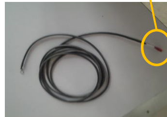
将电压检测线插头与电压检测线连接
