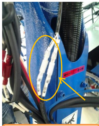
连接碰撞传感器的线
