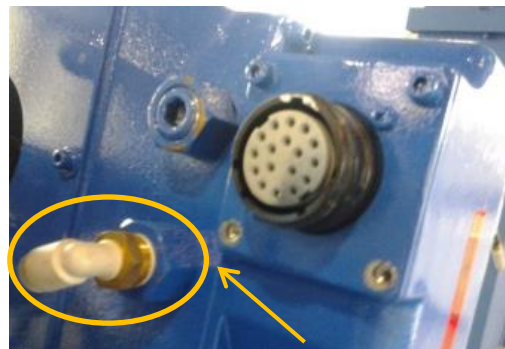
在卸下堵头的接头处装上一触式接头
