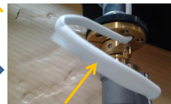
将玻璃纤维管套在碰撞传感器的连接处
