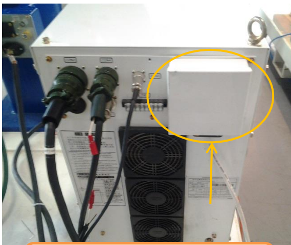
焊机接通电源的地方(380V) 从日本进口的话为200V
