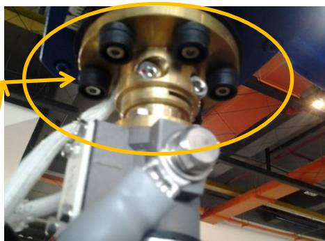
将安装螺丝装入绝缘套管再进行安装
