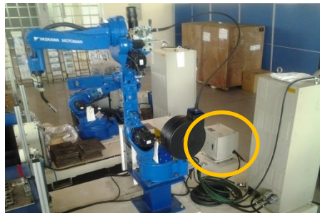
如果没有AC200V的电源，需要使用降压器向DX100提供AC200V
